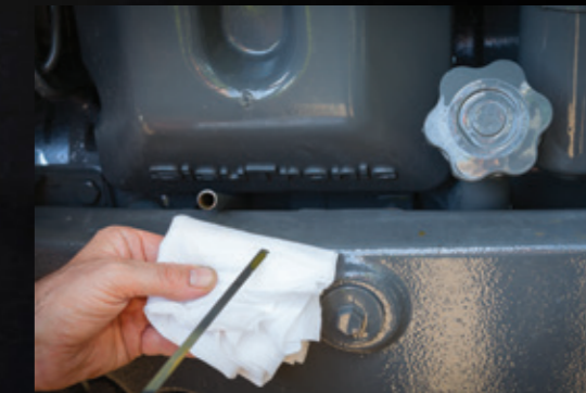
Tack vare smart design på motorhuv och framaxel garanteras bra åtkomst till både motoroljefiltren och oljestickan.
