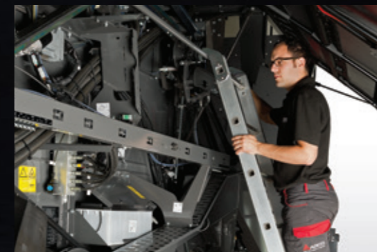
Räcke att kroka fast stegen i gör det enkelt och säkert att inspektera
