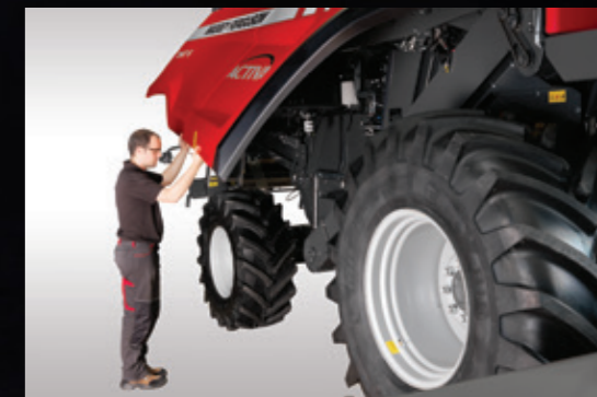
Stora vidöppnande sidoskydd med belysning gör det lätt att komma åt för inspektion
