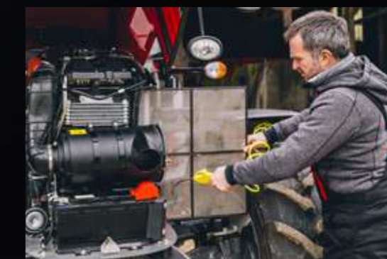
Kylpaketet är lättåtkomligt i syfte att snabba upp och förenkla rengöring.
