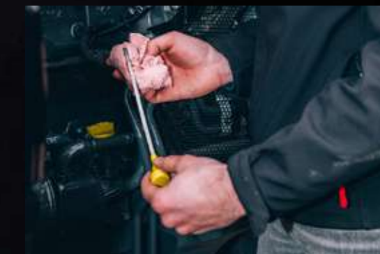
Framaxelns och motorhuvens slimmade midjedesign gör det enkelt att komma åt oljemätstickan och filtret.
