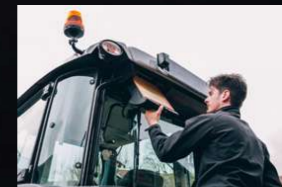
Enkel åtkomst till hyttens luftfilter för rengöring.
