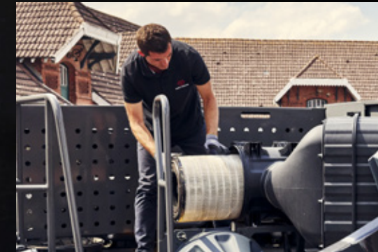
Enkel åtkomst för kontroll och rengöring av luftfiltret
