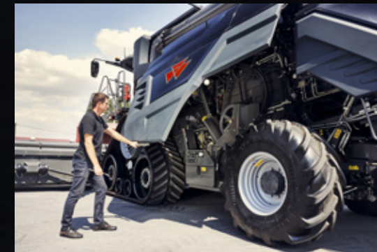
Stora sidoluckor med belysning ger snabb och praktisk åtkomst för inspektion
